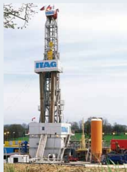
Forage au Dogger à environ 1 600 mètres, pour récupérer une eau à 64°C.
